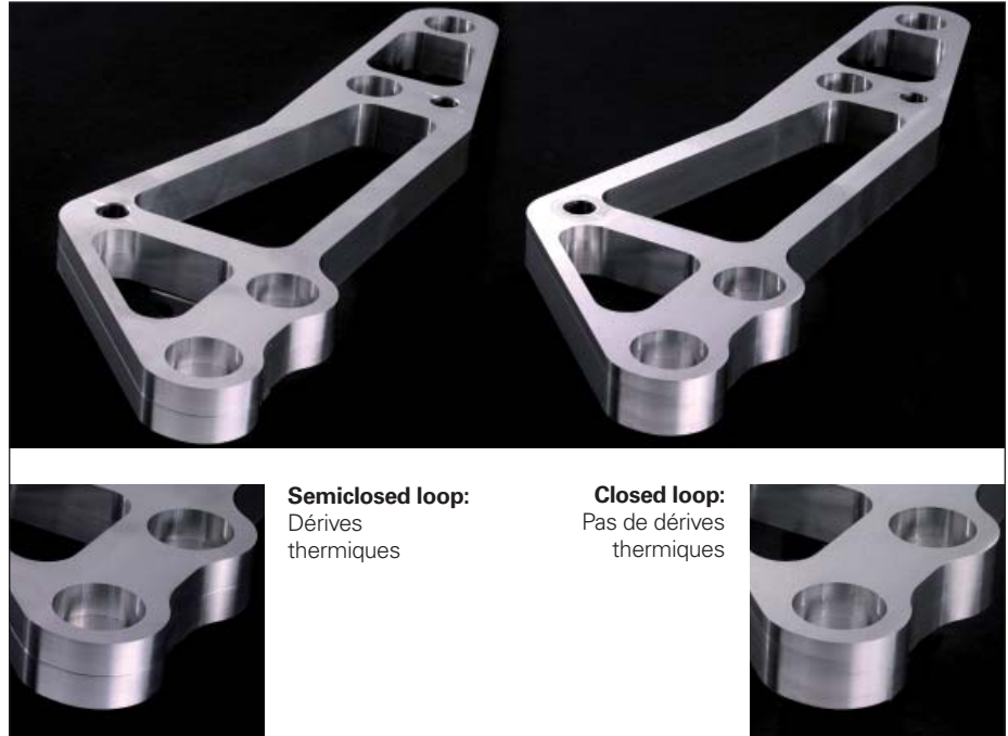
Figure 6 Bras de levier, deux usinages sur une même pièce brute
